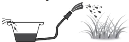
El efluente del FAFA puede utilizarse como riego para algunos tipos de sembrados aprovechando los nutrientes que contiene.
