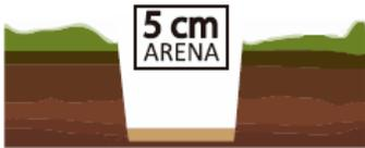
Haga una excavación que permita que el tanque quede enterrado dejando solo la tapa a la vista.
