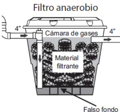
Sobre el falso fondo se deposita el material filtrante para que sobre él se adhieran bacterias anaerobias cuya función es efectuar un filtrado biológico eliminando la mayor parte de la materia orgánica residual.
