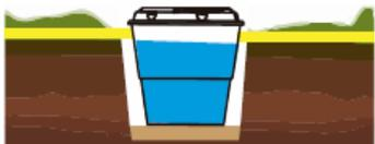
Agregue agua al tanque séptico y al filtro anaerobio y a medida que se va llenando el tanque, se va llenando simultáneamente la excavación con arena o tierra apisonando manualmente (No usar aplanadoras mecánicas) hasta que el tanque quede totalmente instalado.
