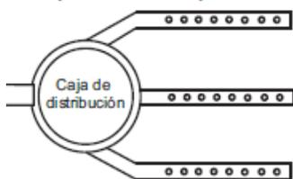
La caja de distribución tiene como objetivo recibir el tubo de 4" que sale del FAFA y repartir el efluente hacia las zanjas del campo de infiltración.
