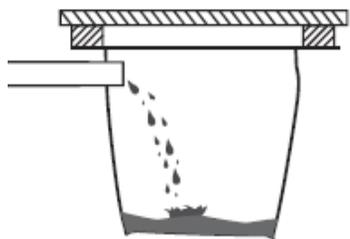
El pozo de absorción es un hueco, preferentemente cónico, Se debe revestir con piedras o ladrillos y llenarlo con piedras o gravilla que servirá como segundo filtro. Además, es recomendable rodearlo con una estructura de concreto para instalar una tapa resistente y así tener mayor seguridad para prevenir el acceso de niños y animales.
