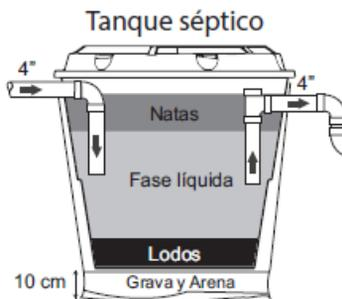
Las aguas negras permanecen en el tanque un mínimo de 24 horas con el fin de que se efectúe el proceso bioquímico y físico que hace que las bacterias anaerobias contenidas en las aguas negras, descompongan la materia orgánica convirtiéndola en gases, líquidos y sólidos que se separan dentro del tanque séptico por procesos físicos, de sedimentación y flotación formando tres capas bien definidas:
